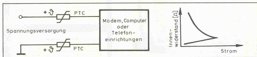
Bild 7. Schutz von Geräten der Datenverarbeitung und -übertragung. Vorteile: Kostspielige Verdrahtung wird vermieden; bei gepaarten PTCs kein Übersprechen oder Brummen; geringe Abmessung gestatten einfache Montage bzw. Einbau.
